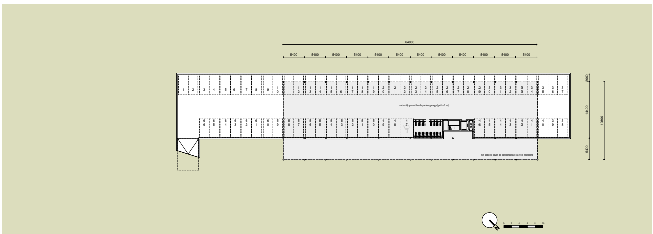
De parkeergarage is door het terras aan het oog onttrokken maar ligt half-verdiept in het maaiveld en is volledig natuurlijk geventileerd.
